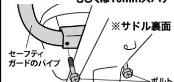
サドル裏のセーフティガードのパイプを固定しているボルト2本をはずし、パイプを上へ抜いてセーフティガード全体を取り外してください。
